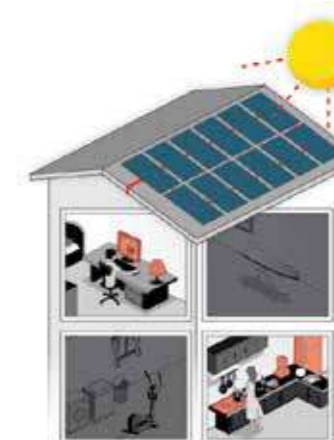
Giorno: Carichi importanti vengono alimentati dapprima dal sistema FV e poi dalla batteria. La batteria può essere caricata da FV se necessario
